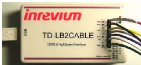
写真 3(a) Flying lead wires 使用時
